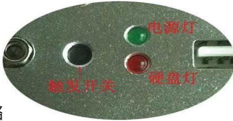
产品标配触发开关，轻接触发键即可开机。
